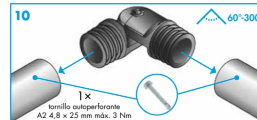
10 Para las esquinas, fije las esquineras de plástico a los extremos de los pasamanos y las barras de media altura. Estas conexiones se deben fijar con dos tornillos auto perforantes de acero inoxidable (4,8 x 25 mm). Puede ajustar cada ángulo por separado y fijarlo con el tornillo integrado en la esquinera.
