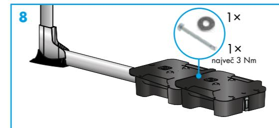
Po namestitvi celotnega sistema varovalne ograje na protiuteži privijte samovrtlalne vijke (4,8 x 50 mm).
