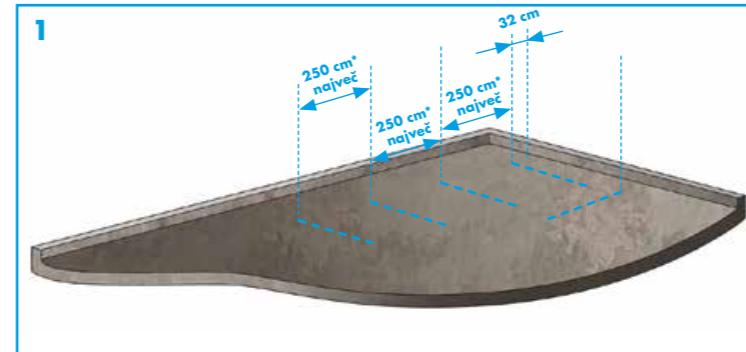
Označite položaj osnovnih elementov v skladu z načrtom namestitve. Odstranite tujke in neravnine, da zagotovite stabilnost sistema.
