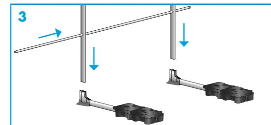
Del ograje vstavite v pripravljene osnovne elemente in potisnite kolenske ograjne cevi v stebričke.
