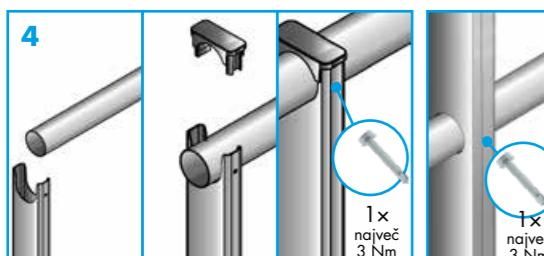
Postavite oprijemalo na stebriček, namestite zaključni element cevi in ga pritrdite z vijakom. Z vijakom na stebriček pritrdite tudi kolensko ograjno cev.
